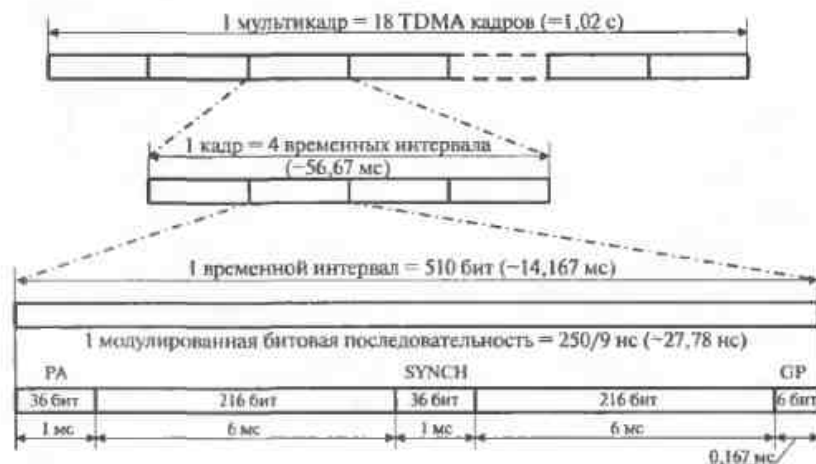
Рис. 3.1. Протокол информационного обмена системы TETRA
