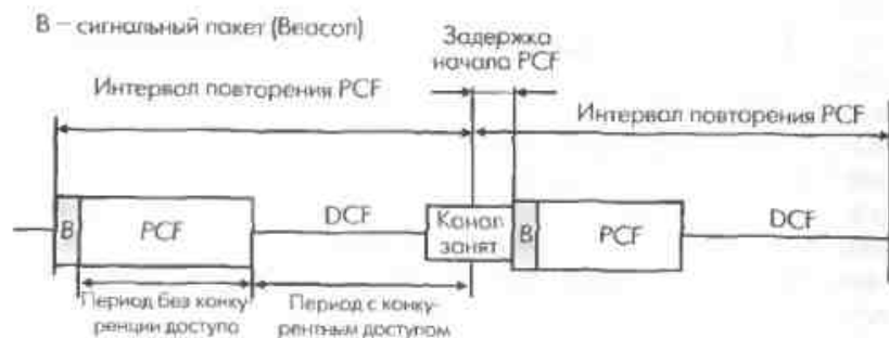
Рис. 10.3. Циклы работы сети в режимах с централизованным (PCF) и распределенным (DCF) управлением
