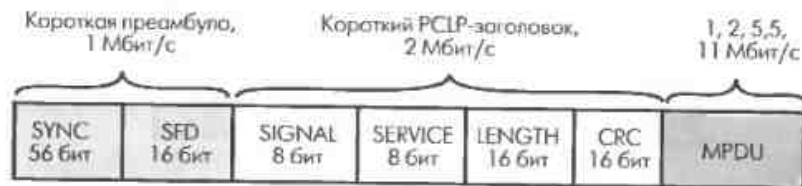
Рис. 10.7. Короткий заголовок кадров сети 802.11b
