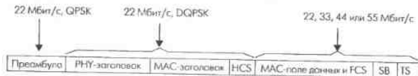
Рис. 9.19. Структура пакетов физического уровня сети IEEE 802.15.3 для скоростей 22, 33, 44 и 55 Мбит/с
