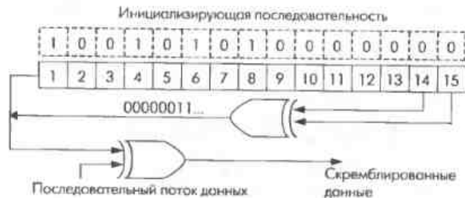
Рис. 11.4. Генерация ПСП для рандомизации данных
