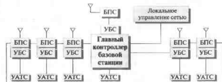
Рис. 3.5. Подсеть TETRA с конфигурацией типа «цепь»
