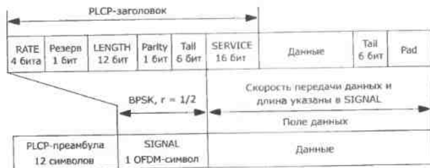
Рис. 10.15. Структура пакетов физического уровня стандарта IEEE 802.11a
